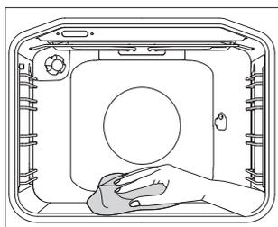
**3** Dopo 30 minuti i residui di cibo nel rivestimento di smalto si ammorbidiscono e possono essere rimossi con un panno umido.
