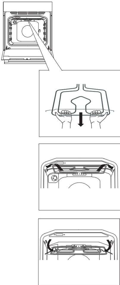
Tirare l'elemento riscaldante fino a quando si libera il perno trasversale che scatta dai punti a sinistra e destra del forno.
