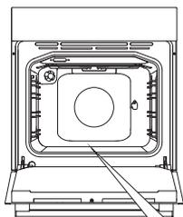
**1** Girare la MANOPOLA PER SELEZIONARE IL SISTEMA DI COTTURA sulla funzione Aqua clean. Impostare il pulsante per la temperatura su 70°.
