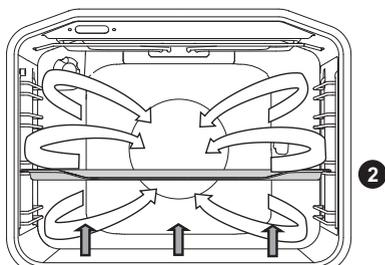
Si usa per la cottura di dolci a bassa lievitazione e per fare le conserve di frutta e verdura. Si usa il 2° livello da sotto e una forma da dolci non troppo alta in modo che l'aria riscaldata circoli anche sul lato superiore del cibo.
