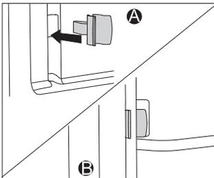
Quando si montano le guide telescopiche estraibili (estrazione completa) con gli inserti catalitici, inserire i fermi forniti nel foro inferiore sulla parete del forno e inserirli nelle guide.
