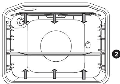
Il riscaldamento nella parte superiore e inferiore del forno trasmette uniformemente il calore all'interno del forno.
